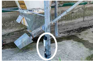
Le capteur est fixé à l'un des pieds du silo. ©Nanolike
